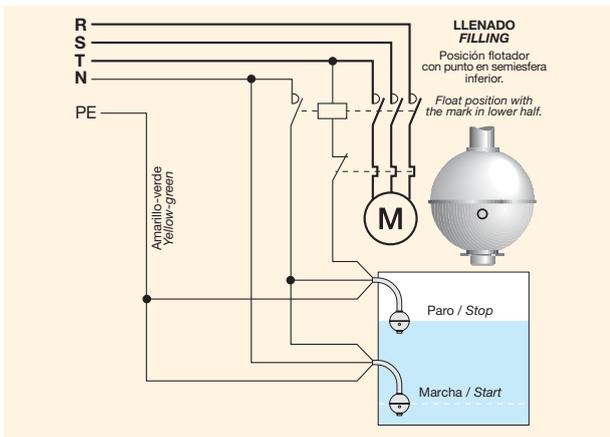
Los interruptores de nivel se suministran con el flotador en posición de llenado, punto marcado en la semiesfera inferior del mismo. Para el funcionamiento de vaciado debe invertirse la posición del flotador de forma que la semiesfera con el punto marcado quede en la parte superior. Para ello desmontar la arandela inferior de retención de su ranura, girar el flotador, y volver a montar la arandela.
